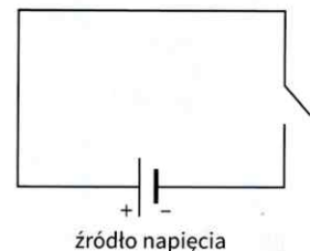
Ryc. 13.3. Obwód bez odbiornika prądu
